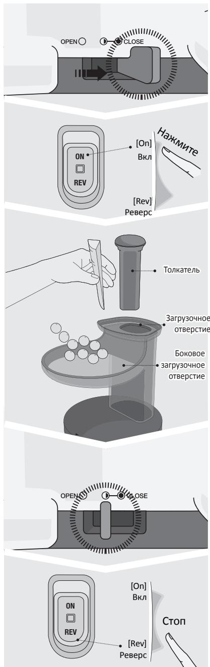
**1** Поместите рычаг перекрытия выхода жмыха в положение "закрыто" (CLOSE) перед тем, как начать работу.
