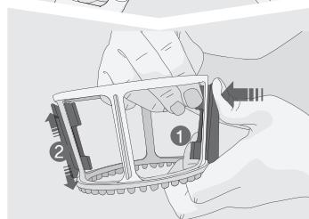
3 Вставьте внутреннее крыло обтирателя достаточно плотно, ①, нажмите на силиконовую щётку от внешней стороны корпуса обтирателя и потяните внутреннее крыло внутрь корпуса обтирателя другой рукой, как показано на схеме. Тяните силиконовый обтиратель до упора. При эксплуатации не полностью собранного изделия существует риск поломки. ② Проверьте, чтобы внешнее крыло было плотно прижато по всей длине к внешней стороне корпуса обтирателя.
