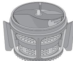
**3** Установите собранные детали из пункта 2 в отжимную корзину, поверните сито из стороны в сторону, чтобы закрепить детали в пазах.
