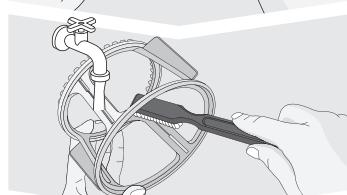
2 При помощи чистящей щётки промойте внутри и снаружи корпуса обтирателя проточной водой.
