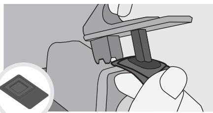
Откройте клапан, придерживайте его с одной стороны и снимите силиконовую крышку с другой стороны, чтобы разобрать.
